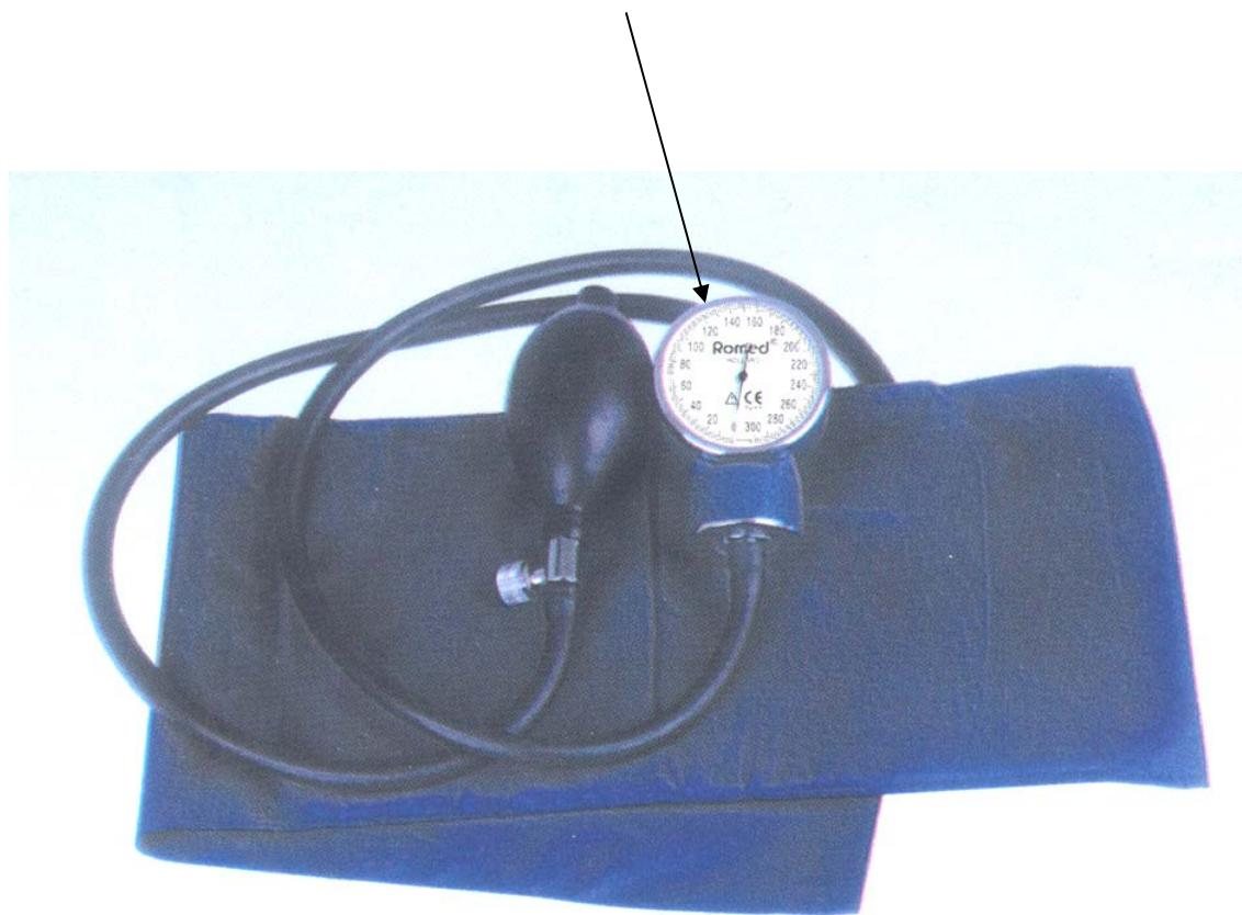
Slika 1: Fotografija tlakomjera za krvni tlak tip ROMED BPM-AN-50 s prikazom mjesta za smještaj ovjerne naljepnice
